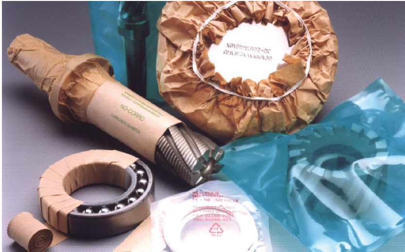
VCI-Verpackungen: Die Wirkstoffe verdampfen und bilden eine schützende Atmosphäre, die sich auf den Metallteilen niederschlägt.
